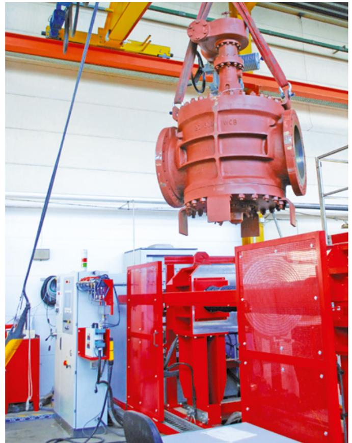
→ **Eigener Druckprüfstand:** Bis DN750/30" (größer auf Anfrage); Prüfungen bis PN420/ANSI2500; Tests gem. DIN EN 12266, API6D, API598 und ANSI etc.; Erkennung geringer Leckagen mittels Laser
