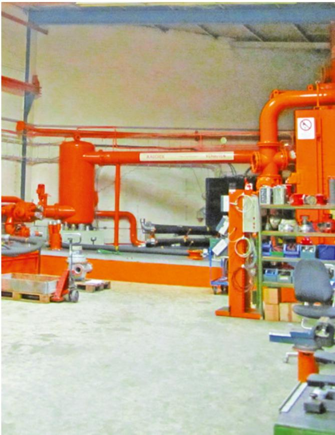
→ **Eigener Eichprüfstand:** PTB zugelassen; 1200 m<sup>3</sup>/h; gravimetrisches Verfahren; Genauigkeit 0,02%; Testmedium: Heizöl/Diesel
